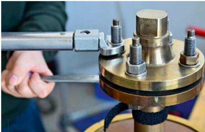
Per Sensor soll der intelligente Drehmomentschlüssel die benötigte Schraubenkraft empfangen können.
